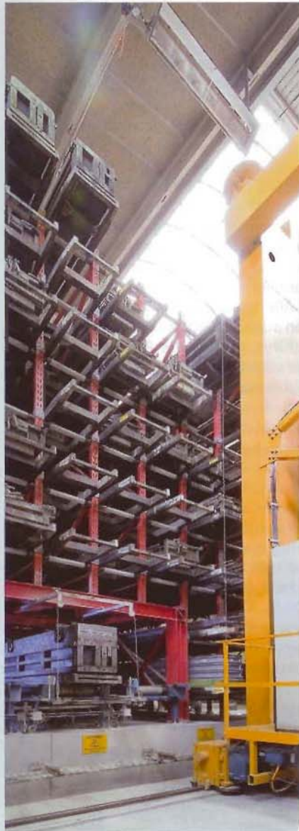
Die bis zu 1,5 t schweren Kassetten werden per RBG ein- und ausgelagert
