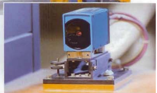
Entfernungsmessgerät zur Positionsbestimmung
