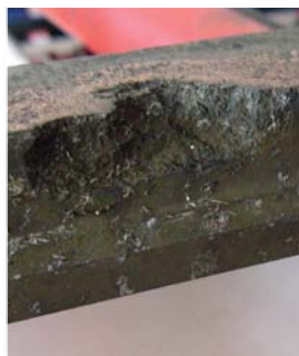
Schleifleiste mit herausgebrochenem Fragment
